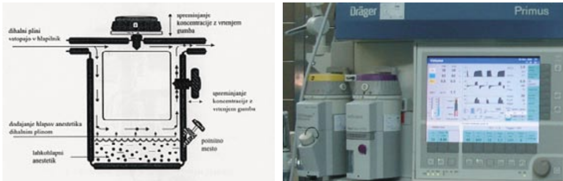
Slika 5. Shematski prikaz delovanja hlapilnika (1) in dveh hlapilnikov za različna hlapna anestetika na anestezijskem aparatu (3)
